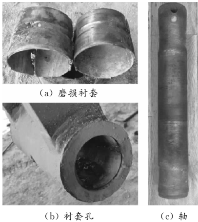
图 1 挖掘机衬套的轴、套磨损状况
